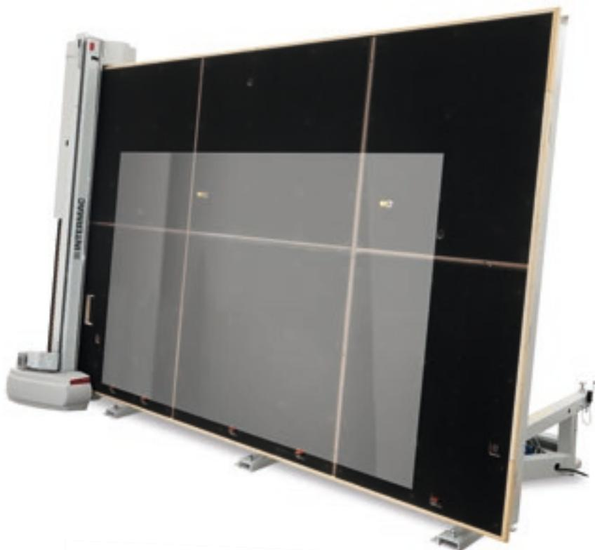
I piedini automatici fungono da appoggio lastra durante il basculamento del piano e, se necessario, come allineatori meccanici della lastra.
