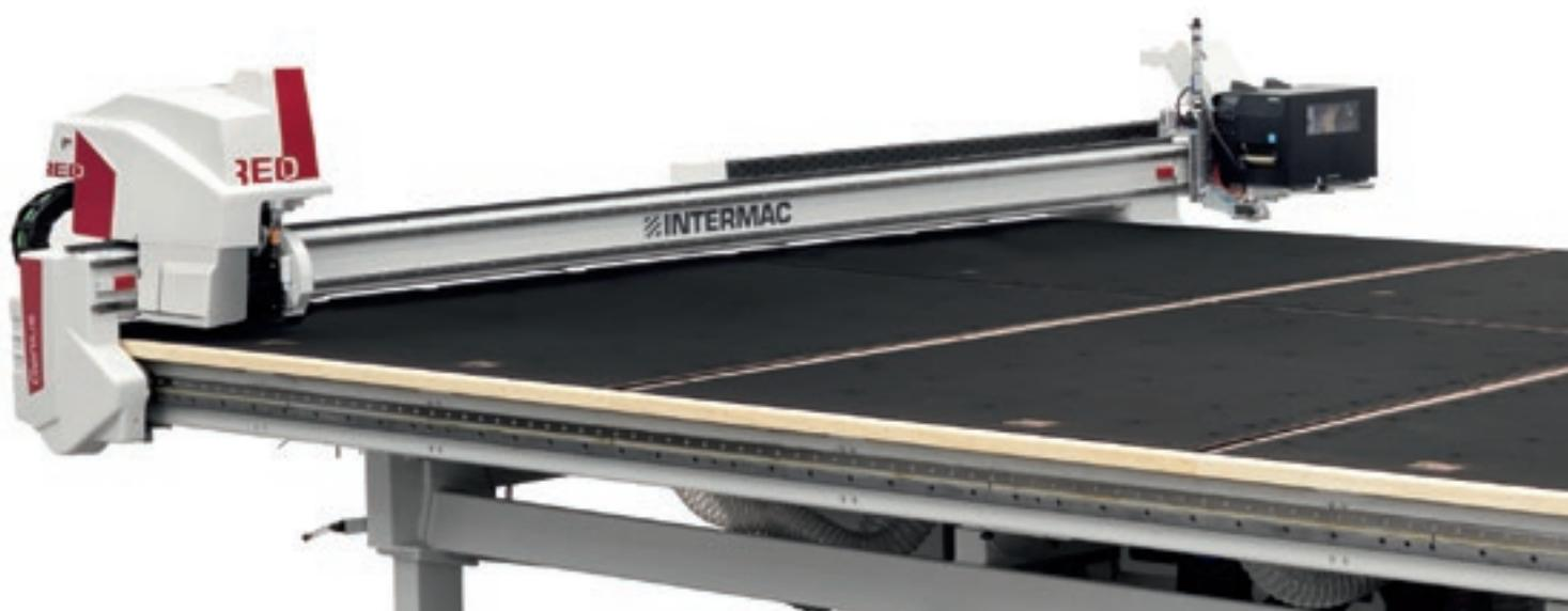
Il basamento della macchina è composto da una struttura rigida e rettificata su cui vengono applicati pannelli di legno rettificati che assicurano la massima planarità dell'area di lavoro, condizione necessaria per una riuscita ottimale dell'incisione e del troncaggio del vetro.
